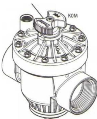
При необходимости обеспечивается управление потоком Вы можете заказать 1" VPG как с системой управления потоком, так и без нее. В варианте с системой управления давление воды в зоне и поток могут регулироваться прямо на клапане для достижения максимальной эффективности. Съемная рукоятка управления потоком, ее размер, удобный для захвата, делают процесс регулировки потока быстрым и легким.
