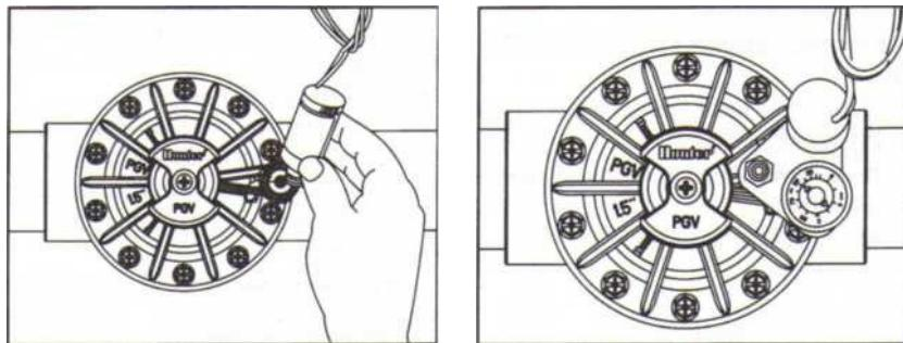
1. Снимите соленоид с ирригационного клапана PGV фирмы Hunter. (1" - клапан с управлением потоком не предназначен к использованию с Accu-Set).
