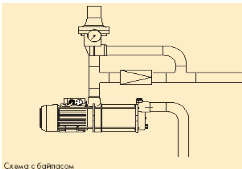
КИТ00, КИТ 01 не требует предварительной заправки воздухом регулировки. Максимальное используемое давление - 10 Bar.
