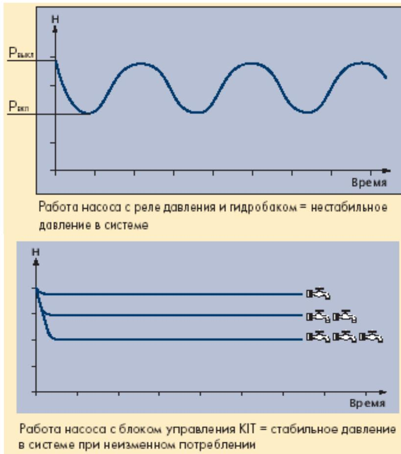
Помимо всего прочего КИТ00, КИТ 01 позволяют избежать частых пусков насоса, которые наблюдаются в станциях с реле давления, тем самым уменьшает вредное воздействие пусковых токов на обмотки электродвигателя.
